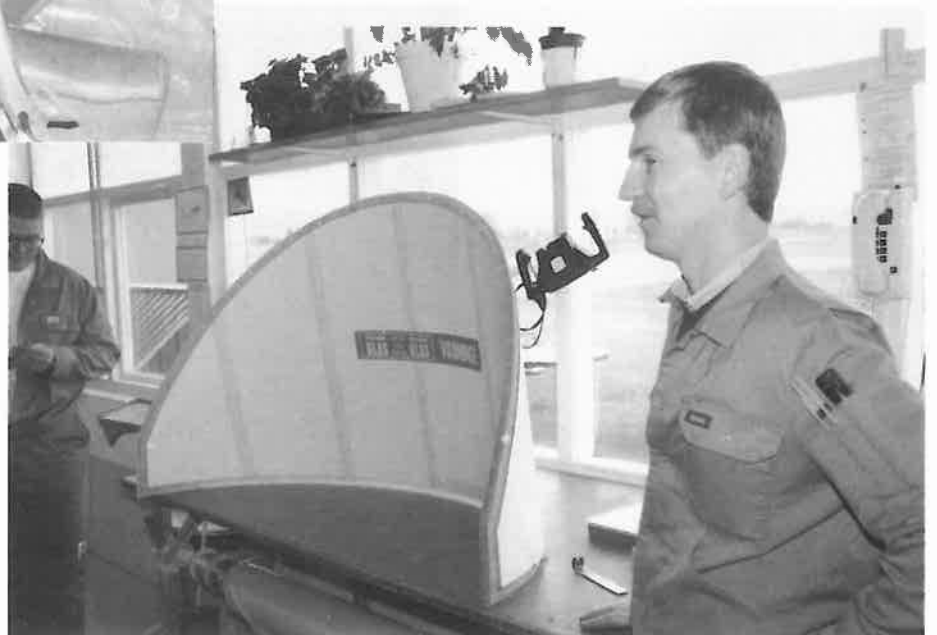
Flygplanreparatör Claes-Åke Bodén räknar med att byta av hugar och frontrutor på SK60 ska ge sysselsättning flera år framåt. Arbetet kräver mycket stor noggrannhet både när det gäller rengöring av hågarna som festsättningen av de relativt dyrbara rutorna.
